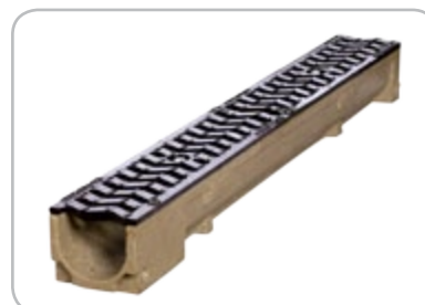
Korytko + ruszt szczelinowy 17mm żeliwny (z zamocowaniem śrubowym) klasa B125
