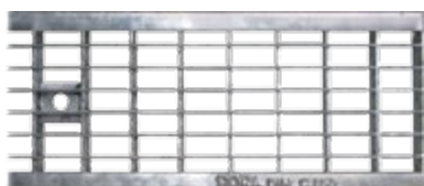
Ruszt kratowy ocynkowany / nierdzewny Zamocowanie typ I/IV M8 B=100: klasa B125, C250 B=150/300: klasa B125 B=200: klasa C250
